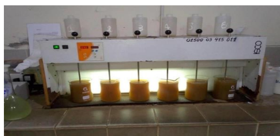
Figure 5.. Floculateur à 6 postes en marche, en essai du jar test avec la solution de gel de figuier de barbarie (Auteur, 2023).
