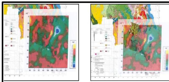
**Figure 10.** Superposition des cartes géologique et gravimétrique
